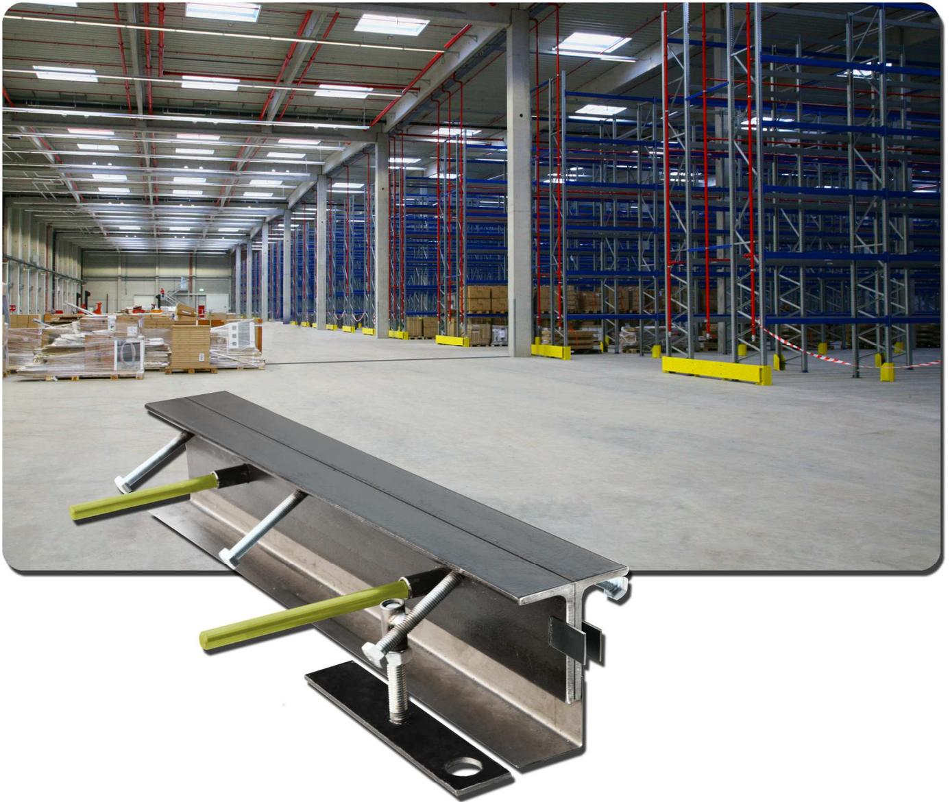
Schwerlastfugenprofil aus Stahl, Stahl verzinkt (vz) oder Edelstahl (VA) für die Ausbildung und als Schutz von Fugen vor Beschädigungen in hochbeanspruchten Betonnutzböden mit niedrigem Querschnitt im Rauminnen.
