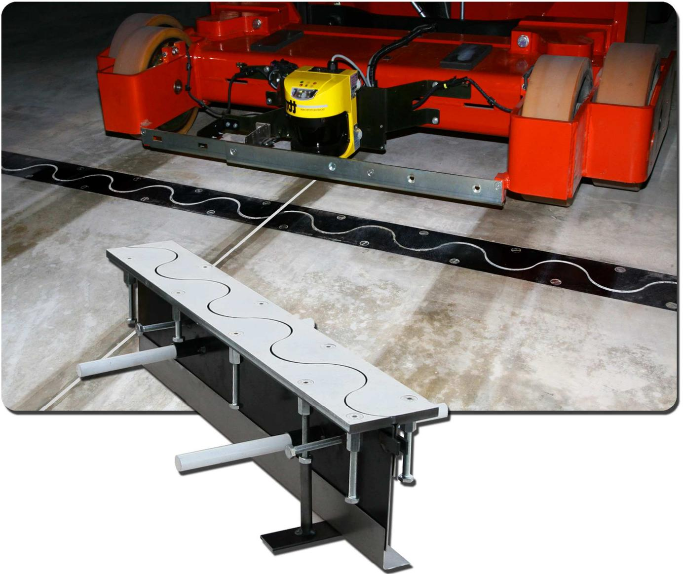
Schwerlastfugenprofil aus Stahl, Stahl verzinkt (vz) oder Edelstahl (VA) für die Ausbildung und als Schutz von Fugen vor Beschädigungen in hochbeanspruchten Betonnutzböden im Rauminnen. Die Fugenausbildung als Sinuswelle garantiert durch ununterbrochenen Kontakt der Laufräder mit dem Schwerlastfugenprofil ("System Fugenlos") ein erschütterungsfreies Überfahren mit Flurförderfahrzeugen unabhängig von Größe und Härte der Bereifung.
