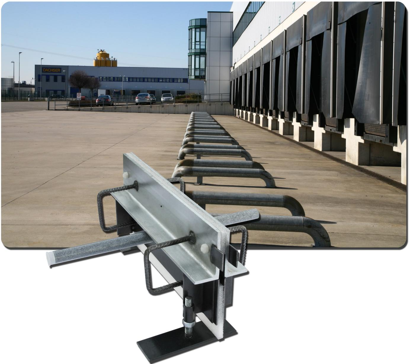
Schwerlastraumfugenprofil aus Stahl, Stahl verzinkt (vz) oder Edelstahl (VA) für die Ausbildung und als Schutz von Fugen vor Beschädigungen in hochbeanspruchten Betonnutzflächen, die temperaturbedingten Längenveränderungen unterliegen, z.B. Freiflächen, höhenjustierbar mit Raumfugenfließbarriere als Durchlaufschutz.
