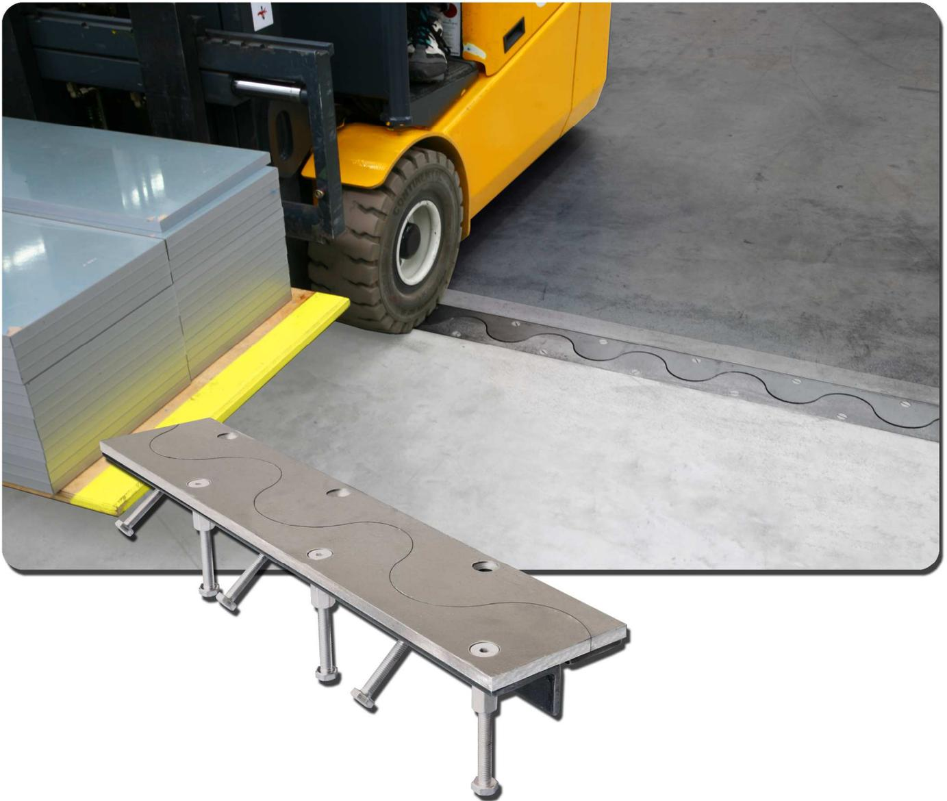
Schwerlastfugenprofil aus Stahl, Stahl verzinkt (vz) oder Edelstahl (VA) für die Ausbildung und als Schutz von Fugen vor Beschädigungen im Übergang von vorhandenen (Bestand) zu neuen Betonnutzböden im Rauminnen. Die Fugenausbildung als Sinuswelle garantiert durch ununterbrochenen Kontakt der Laufräder mit dem Schwerlastfugenprofil ("System Fugenlos") ein erschütterungsfreies Überfahren mit Flurförderfahrzeugen unabhängig von Größe und Härte der Bereifung.
