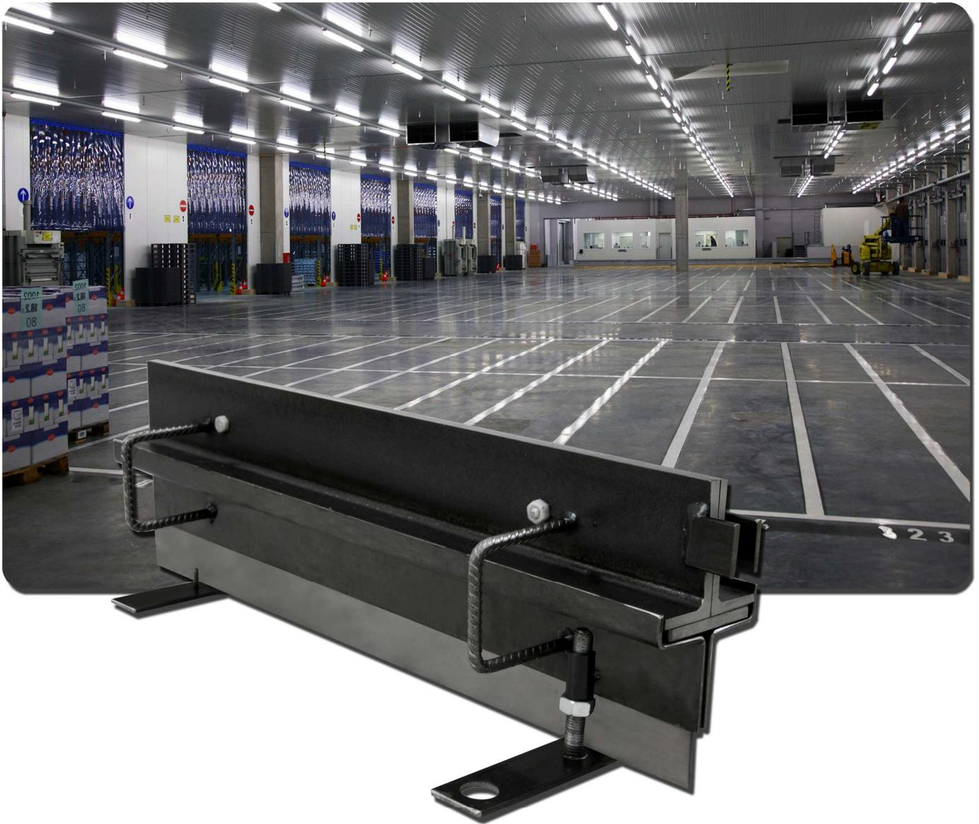
Schwerlastfugenprofile (Con KS 140+ / Con KS 170+ / Con KS 210+) aus Stahl, Stahl verzinkt (vz) oder Edelstahl (VA) für die Ausbildung und als Schutz von Fugen vor Beschädigungen in hochbeanspruchten Betonnutzböden im Rauminnen, Spezialquerkraftübertragung auf voller Profillänge, höhenjustierbar mit Fließbarriere als Durchlaufschutz.
